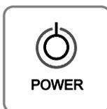
Die POWER-Leuchte leuchtet immer dann auf, wenn der Drucker eingeschaltet ist. Sie blinkt, wenn der Drucker einen Selbsttest druckt oder sich im Standby-Zustand befindet. Warten Sie immer erst, bis diese Leuchte aufhört zu blinken, bevor Sie den Drucker zu benutzen beginnen oder ausschalten.
