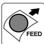
Drücken Sie diese Taste, um Papier vorzuschieben oder um den Selbsttest zu starten. Mit dieser Taste können Sie auch in den Hexadezimaldump-Modus wechseln. (Für Informationen zum Selbsttest siehe Anleitung unter „Selbsttest“ (8) in diesem Kapitel.) (Für Informationen zum Hexadezimaldump-Modus siehe Anleitung unter „Hexadezimaldump“ in Kapitel 9.)
