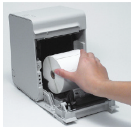
Papier- und Etikettenrollen bis 90 mm Durchmesser lassen sich kinderleicht wechseln
